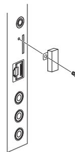
※mini B-CASカードを取り外す場合、mini B-CASカードを押すとカードが少し出てきます。そのまま抜いてください。ICチップに触れないよう注意してください。
