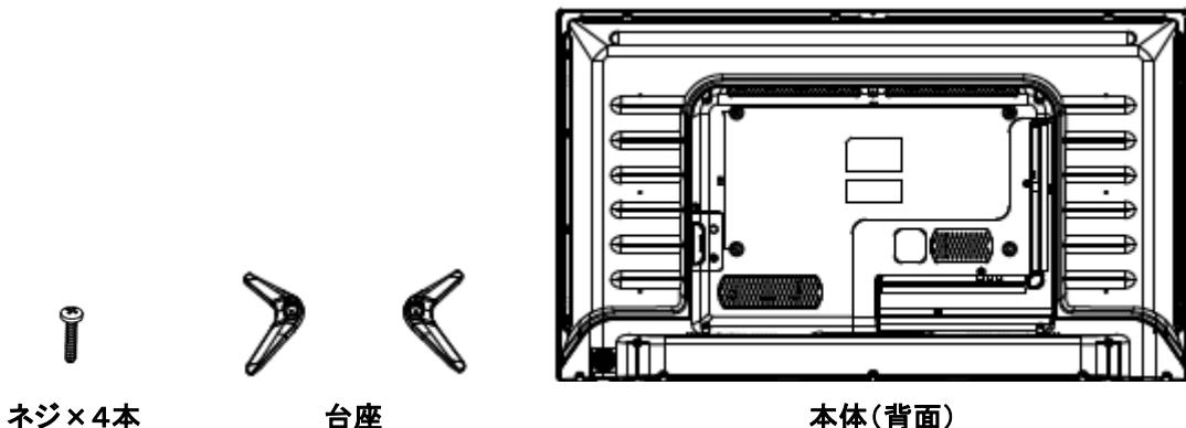
2. 台座のネジ穴と本体のネジ穴を合わせて、ネジで止めてください。
