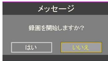
【はい】を選択します。録画開始し、液晶画面の左上に【録画】が表示され、本体右下のLEDランプが赤と緑に点滅します。
